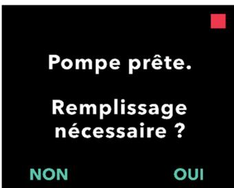
*Remarque* : si vous devez réaliser un remplissage et que cet écran ne s'affiche pas, dans l'écran d'état, sélectionnez MENU, faites défiler les options et sélectionnez « Remplac. accessoires », puis faites défiler les options et sélectionnez « Remplir perf. ».
