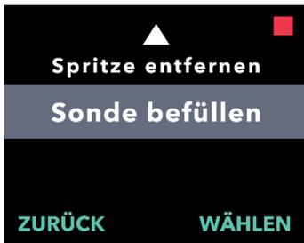
2. Markieren Sie mithilfe der Pfeiltasten die Menüoption **Sonde befüllen**.
