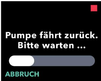
**2. Warten Sie, bis der Pumpenkolben eingefahren ist.**
