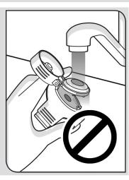
Risciacquare il nebulizzatore utilizzando almeno 100 ml di acqua distillata. Procedere come segue:
